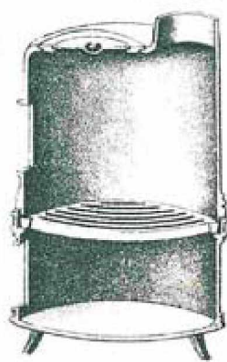
Vue intérieure entièrement en fonte
