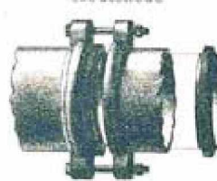
Vue et Coupe d'un joint avec sa bague en tôle et son caoutchouc
